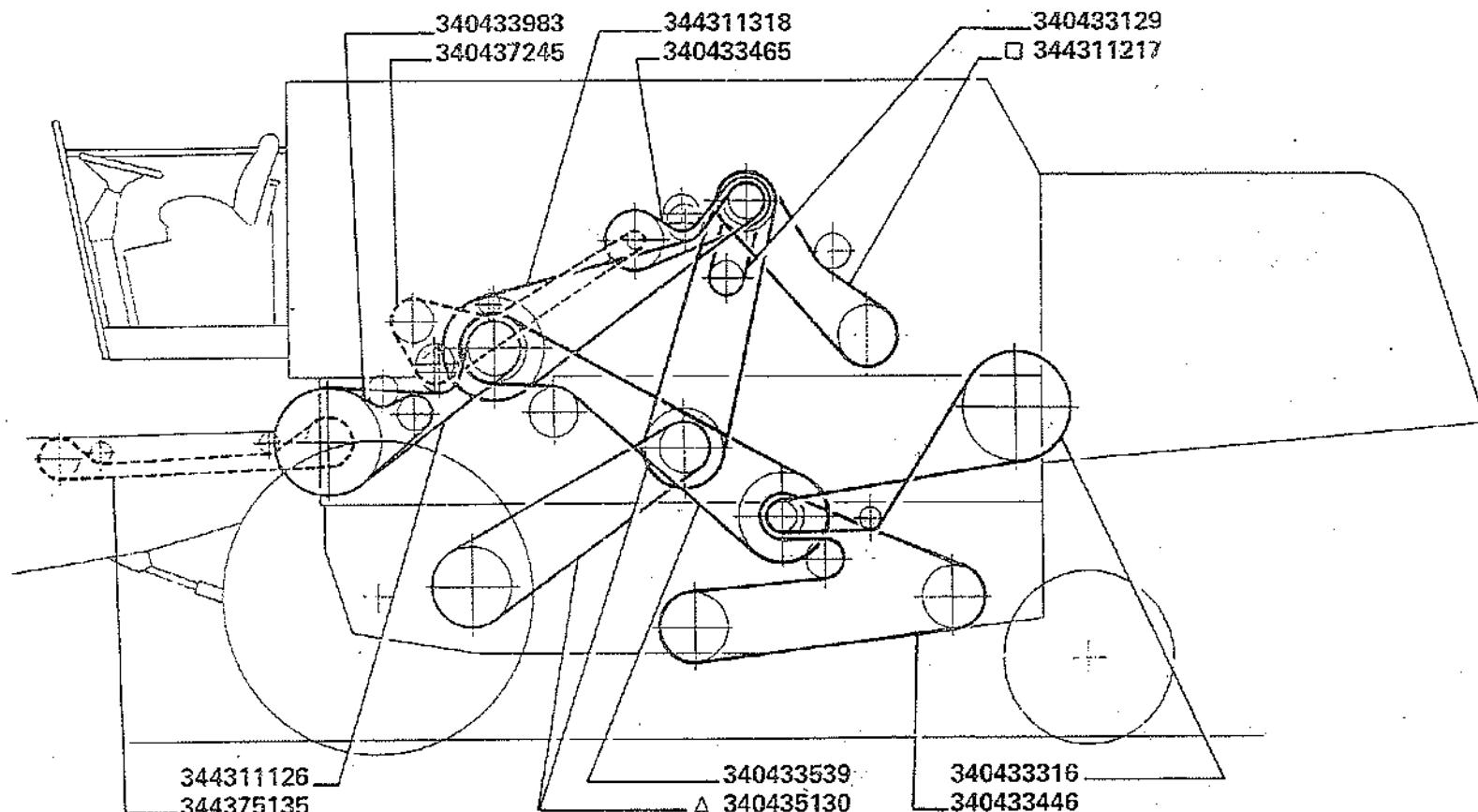
△ Trazione meccanica - *Traction Mécanique - Mechanischer Antrieb - Mechanical Transmission - Traccion Mecánica*
